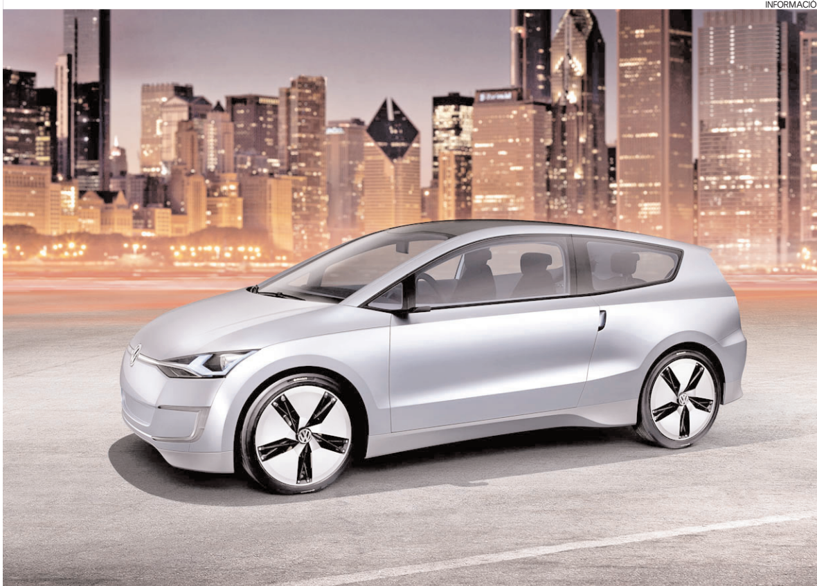
Este diseño combina un motor diésel de 54 caballos y uno eléctrico de 13.
