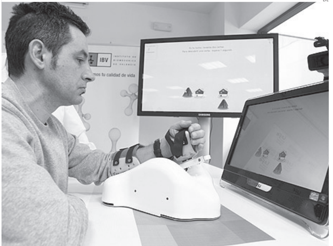
El sistema robótico móvil, denominado 'Arm Assist', ayuda a paliar el deterioro neuromuscular.
