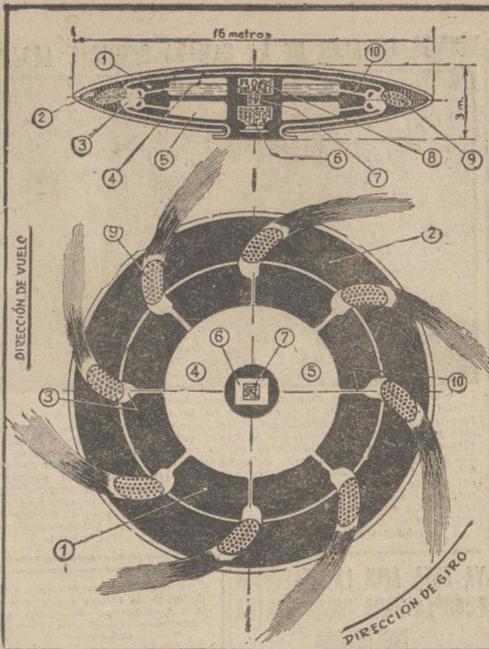
ESQUEMA DE UN PLATILLO VOLANTE.—1: Cuerpo móvil del «platillo».—2: Cuerpo giratorio del mismo.—3: Compresor de conducto de adhesión.—4: Depósito de alcohol.—5: Depósito de oxígeno.—6: Bloque radar de orientación y observación por televisión.—7: Cerebro electrónico con piloto automático.—8: Bloque de radar, dirección y emisor y receptor.—9: Desembocadura de turboreactores.—10: Conductos de alimentación de alcohol y oxígeno.
