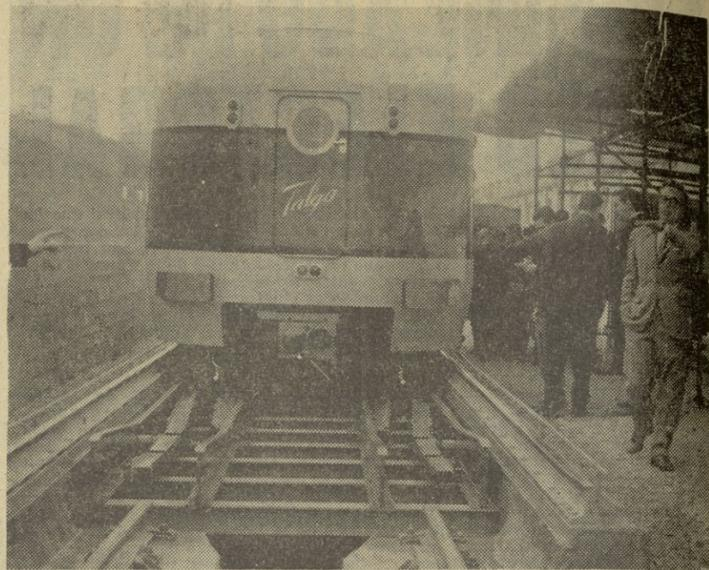
Don José María Oriol, inventor del ferrocarril «Talgo», presentando a los periodistas el nuevo aparato que permitirá automáticamente adaptar el tren de rodaje del ferrocarril «Talgo» del ancho de vía español (1,668 mts.), al ancho de vía europeo (1,435 mts.), en presencia del creador de este revolucionario sistema, don Angel Torán. — (Foto EUROPA PRESS)
