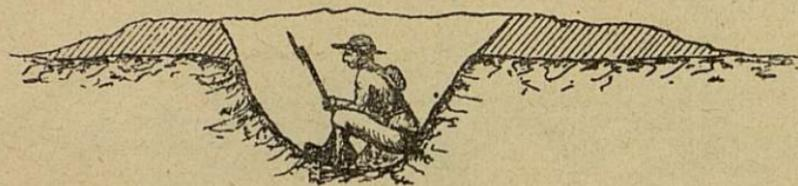
*En las inmediaciones de las tiendas se hacen zanjas de 0.50 à 0.60 mts. de anchura y 0.80 m. de altura, recubriendolas con un lienzo.*
