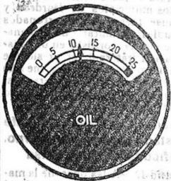
MANÓMETRO DE ACEITE.—Indica la buena marcha del sistema de lubricación.
