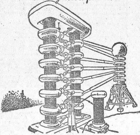
se halla en Hamburgo, construida por SIEMENS REINIGERWERKE, Berlin. El gigantesco aparato es capaz de sostener en servicio permanente una tensión continua-constante de un millón de voltios. Para igualar sus efectos mediante radium serían precisos 10 kilos por valor de 400 millones de dólares.
