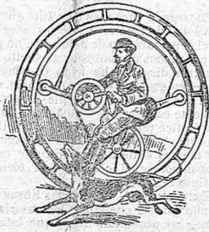
En este dibujo está bien indicada la máquina en que verificó el *record*. Para girar á derecha é izquierda bastaba inclinar el cuerpo á uno ú otra lado. La pieza de hoja de lata colocada encima de su cabeza resguardábase del polvo ó barro que caía de la rueda.
