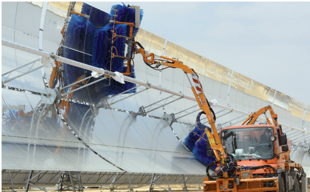
El vehículo que han diseñado específicamente para limpiar los paneles solares de espejos curvos.
