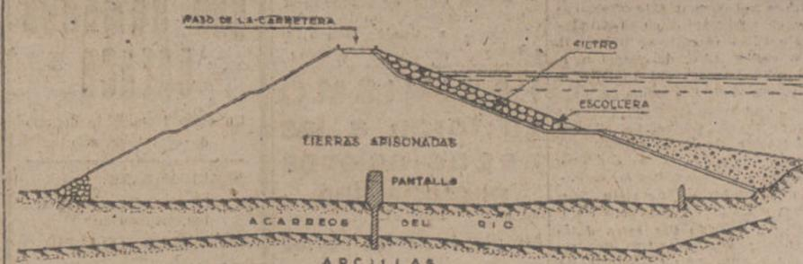
Corte transversal de la presa del pantano del Cubillas, cuyo apisonado se hace a base de rodillos especiales que permiten la mayor homogeneidad en el volumen total apisonado.
