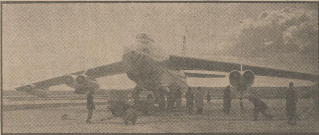
Un momento del aterrizaje en una de las pistas del aeropuerto de Barajas, del nuevo modelo de bombardero norteamericano de tipo medio, con motores de reacción «B-47», procedente de una base próxima a Casablanca. Dispone de cuatro motores de reacción y se sirve de un paracaídas a fin de frenar su velocidad en el momento de tomar tierra.—(Fot. CIFRA GRAFICA).
