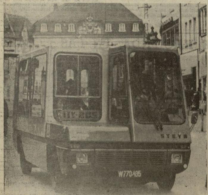
Este es el nuevo vehículo, de veinte asientos, puesto en circulación en Alemania occidental. Tiene dos ventajas: no consume gasolina ni contamina el ambiente, ya que está accionado por un gas a alta presión. Llevará a cabo una prueba de un mes, para comprobar sus resultados. — (Telefoto CIFRA GRAFICA - UPI)
