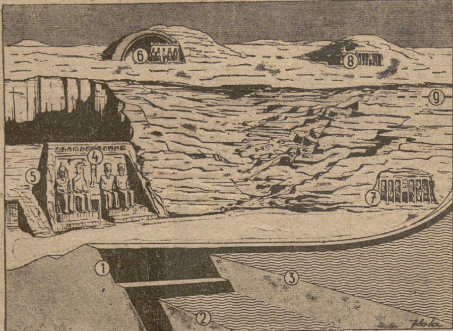
(1) Dique de protección contra las aguas del Nilo. (2) Actual nivel del agua. (3) Nivel del agua, terminado el desmontaje. (4) La fachada del Templo de Ramsés separada de la roca. (5) El Templo de Ramsés en su nuevo sitio con la cúpula de hormigón. (6) El Templo de Ramsés en su nuevo sitio con la cúpula de hormigón. (7) El Templo de la Reina Nefertari. (8) Nuevo sitio del Templo de la Reina Nefertari. (9) Nivel del agua definitivo, a dos metros debajo de la meseta.
