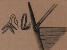
Figura 50.—Gancho de madera y anillas para suspender la tolva.
